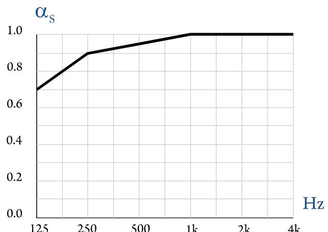
— Палитра CX 2D 40мм, возд. зазор 100мм,  $\alpha_w=1.00$
